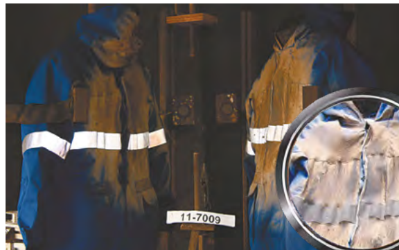
Фурнитура сохранила свою функциональность, верхний слой ткани обуглен, не поддерживал горение, не плавился.
