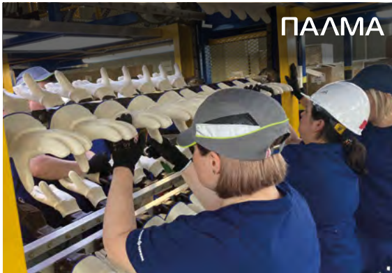
Современная линия по производству перчаток с покрытием из нитрила. Фабрика «ПАЛМА» в г. Узловая (Тульская область)
